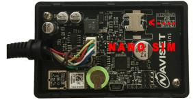
Для кабельного подключения к персональному компьютеру используется USB интерфейс, имеющий разъем Micro USB. Кабель USB в комплекте не поставляется. Опция «Использовать облачный сервис» включена по умолчанию, поэтому после установки SIM карты и подачи питания прибор автоматически подключится к облаку, поэтому использовать кабельное USB соединение не обязательно. На SIM карте должна быть включена услуга GPRS интернет.
