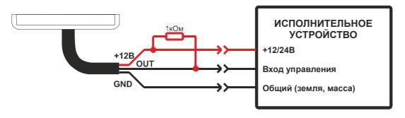
**2. Активный уровень высокий (+питания).** Соедините провод «GND» с клемой «-» (минус), провод «+12В» с клемой +12/24В (клема подключения питания исполнительного устройства). Подключите через группу нормально разомкнутых контактов реле провод «+12В» и Вход управления. Выход «OUT» и провод «+12В» подключите к катушке управления реле.
