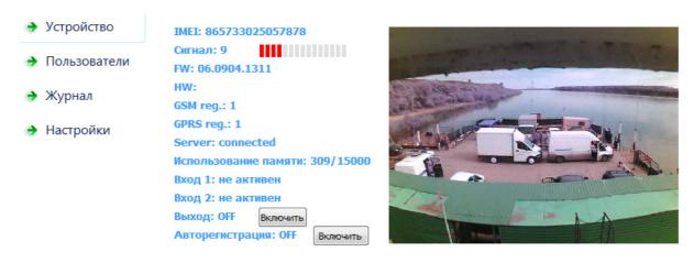
Из данной панели можно осуществлять ручное управление выходом для тестирования работоспособности GSM ключа и подключенных к нему исполнительных устройств.
