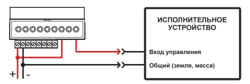
2. **Активный уровень низкий (земля).** Соедините контакт реле «ОБЩ» со входом управления исполнительным устройством. Контакт реле «Н.Р.» с клеммой «-» (минус). Контакт реле «Н.З.» с клеммой «+» 10-30В. Если вход исполнительного устройства не защищен от «дребезга контактов» или не имеет встроенного подтягивающего резистора, рекомендуется устновить внешний резистор 1кОм.
